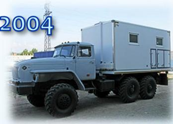
Изготовлена первая лаборатория на шасси Урал по бескаркасной технологии
