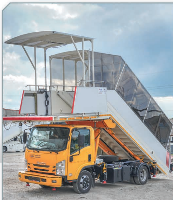
Пассажирский трап на базе шасси ISUZU NPR 75 L-H
