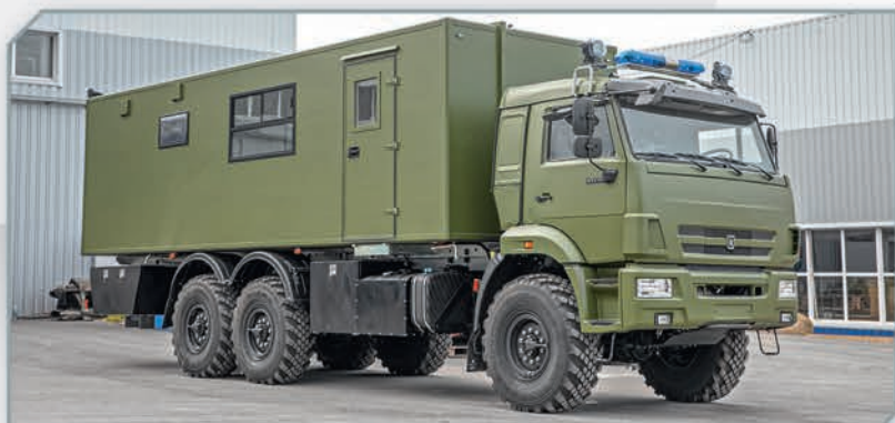
ТБМ (штабной автомобиль) на базе шасси Камаз 43118
