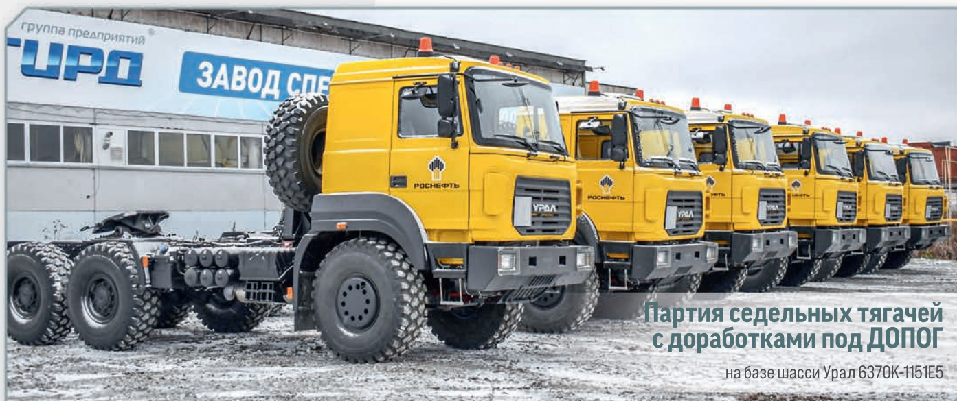
Седелный тягач с доработками под ДОПОГ на базе шасси Урал 63701
