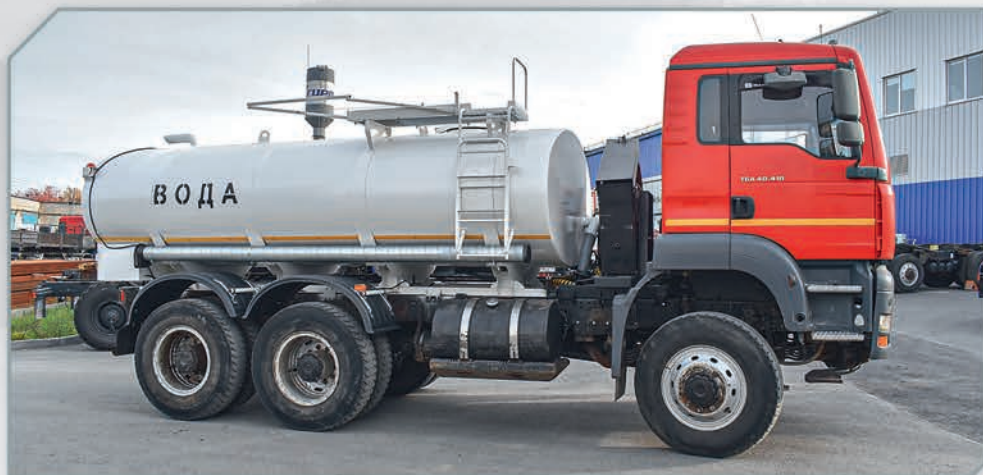
АЦПТ-10 на базе шасси Ман
