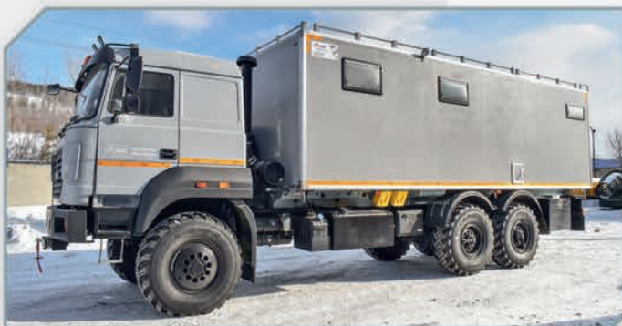
Автодом на базе шасси Урал 4320
