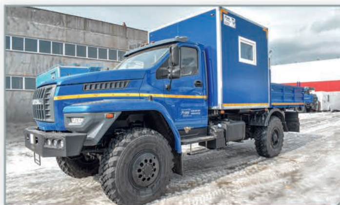
ГПА 6 пассажирских мест с бортовой платформой на базе шасси Урал Некст
