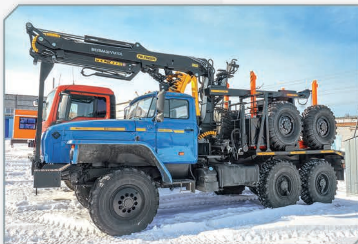
Лесовоз с прицепом ропслуском и КМУVM-10 на базе шасси Урал 5557
