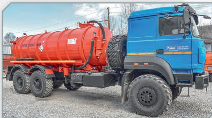
АКН-12 на базе шасси Урал 4320-4972-82
