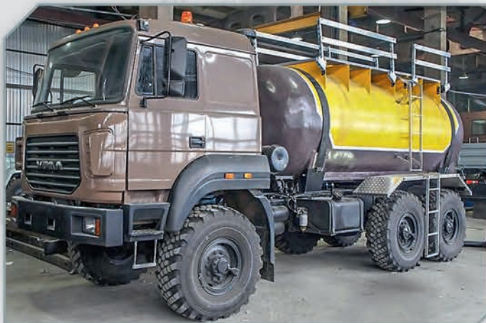
Автоцистерна из химостойкого стеклопластика на базе шасси Урал 5557-4112-80М
