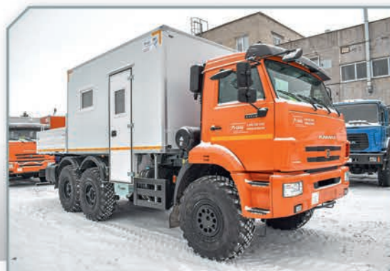
ТБМ с бортовой платформой на базе шасси Камаз 43118
