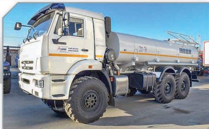
АЦПТ-10 на базе шасси Камаз 43118
