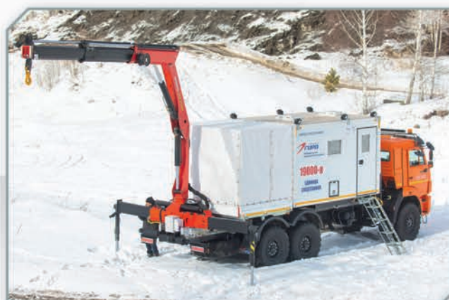
ПАРМ с бортовой платформой с тентом и КМУ
