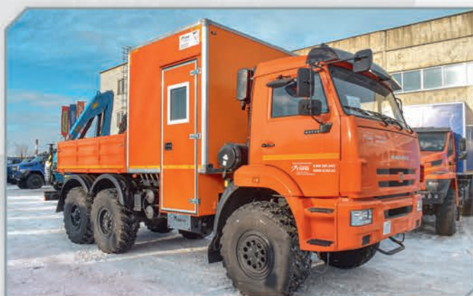
ГПА 6 пассажирских мест с бортовой платформой и КМУ ИНМАН ИМ-50 на базе шасси Камаз 43118
