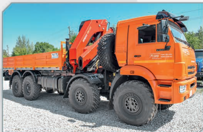
Бортовой автомобиль с КМУ ИМ-320 на базе шасси Камаз 63501
