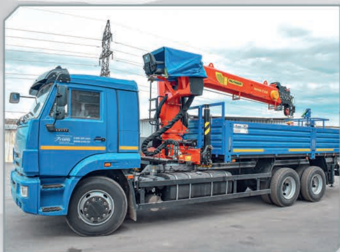
Бортовой автомобиль с КМУ ИТ-200
