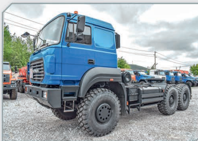
Седелный тягач с доработками под ДОПОГ на базе шасси Урал 63701
