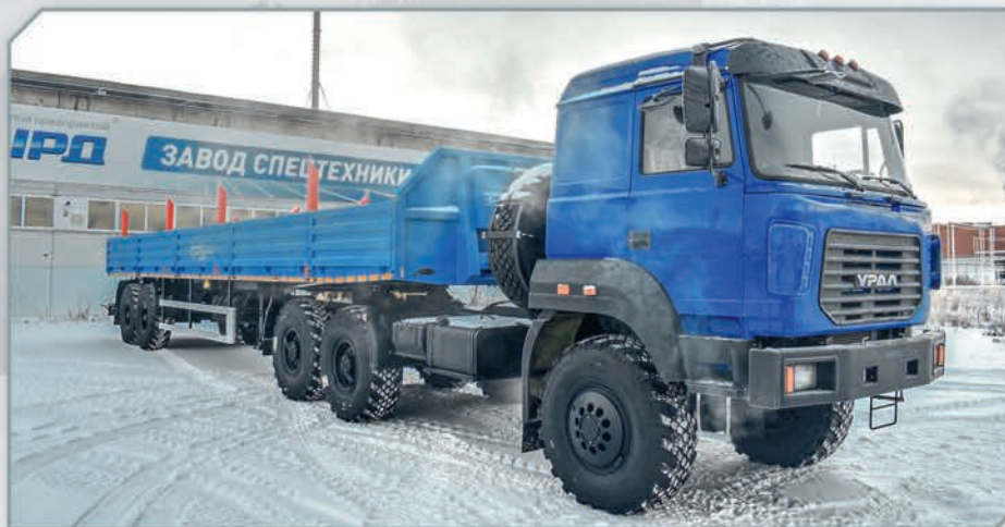
Седельный тягач с бортовым полуприцепом на базе шасси Урал 44202
