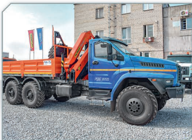
Бортовой автомобиль с КМУ РК13.501
