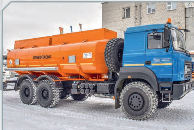
АЦН-20 на базе шасси Урал 63701К-1952Е5
