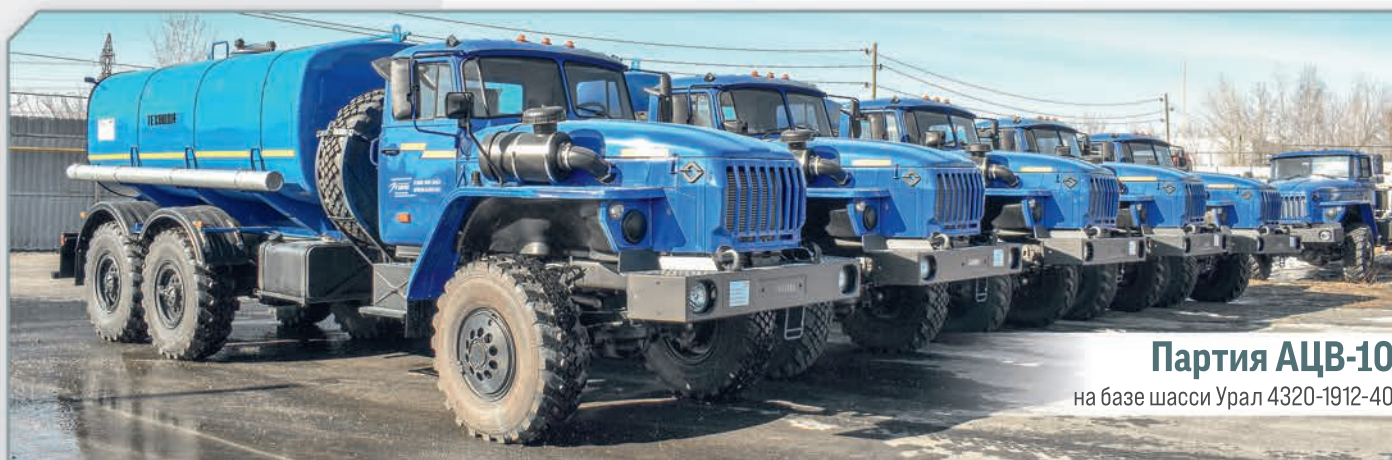
АЦВ-10 на базе шасси Урал 4320-6952-72Е5Г38
