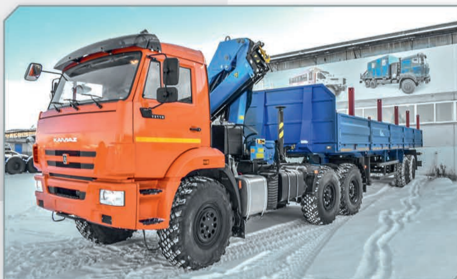
Седельный тягач с КМУ ИНМАН ИМ-95 с бортовым полуприцепом на базе шасси Камаз 43118
