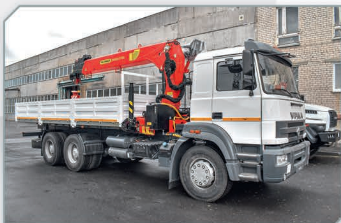
Бортовой автомобиль с КМУ ИТ-150 на базе шасси Урал С34520
