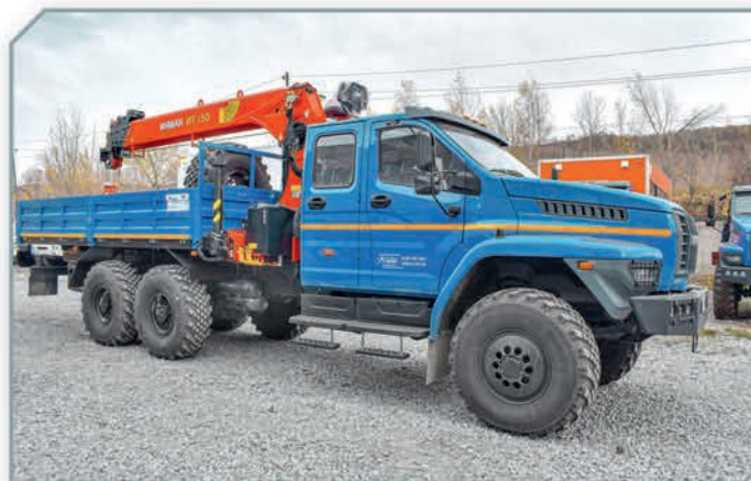
Бортовой автомобиль с КМУ ИТ-150 на базе шасси Урал Некст
