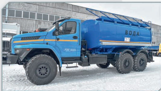
АЦВ-10 на базе шасси Урал 4320-6952-72Е5Г38
