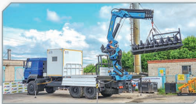
Многофункциональный кран-манипулятор МКМ ИНМАН ИМ-240-04 на метановом шасси Урал 4320
