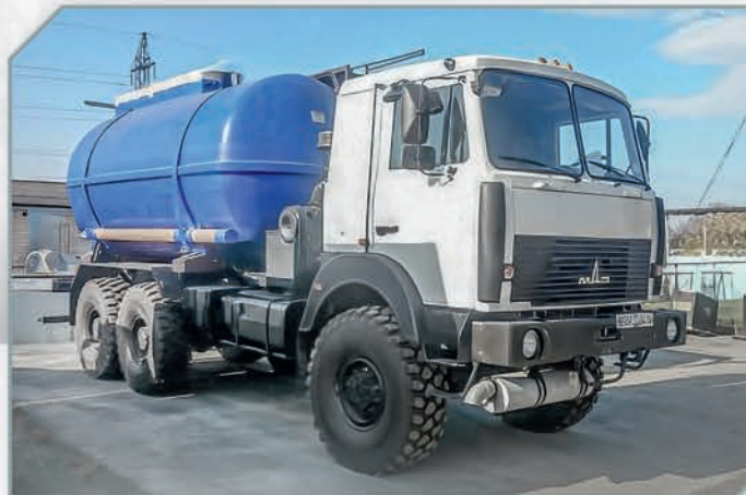
Автоцистерна из химостойкого стеклопластика на базе шасси МАЗ 6317Х5
