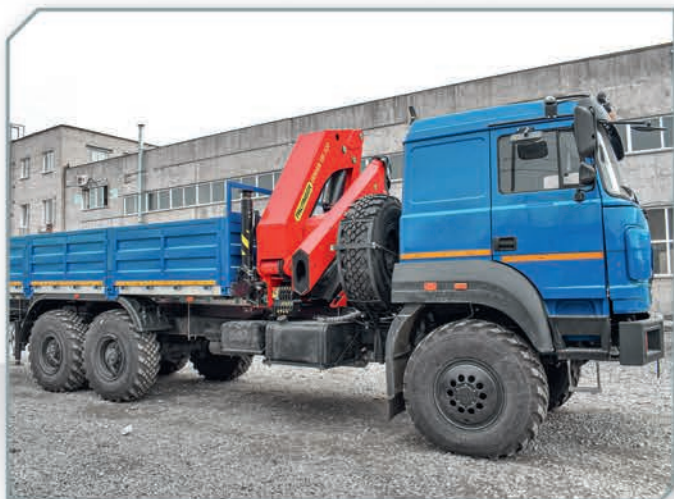
Бортовой автомобиль с КМУ ИМ-320
