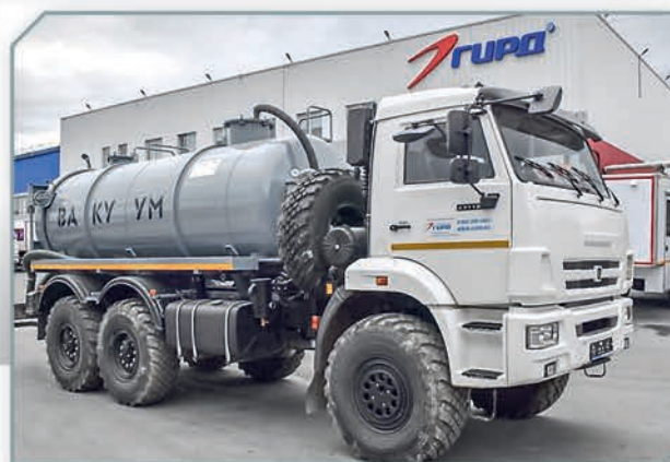
МВ-10 на базе шасси Камаз 43188
