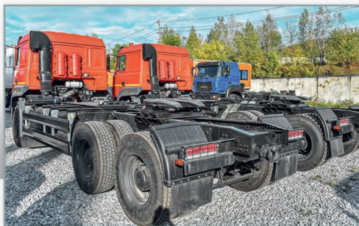
Партия седелных тягачей с доработками под ДОПОГ на шасси Урал 35510
