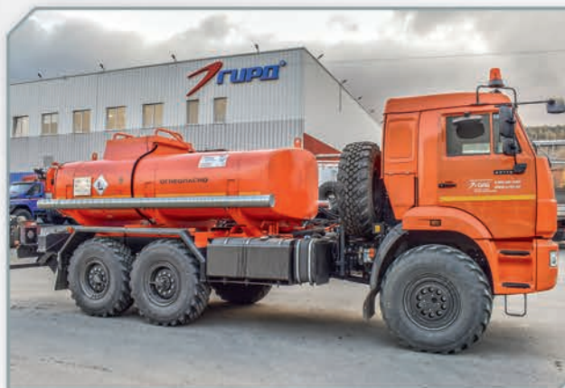
АТЗ-8 на базе шасси Камаз 43118
