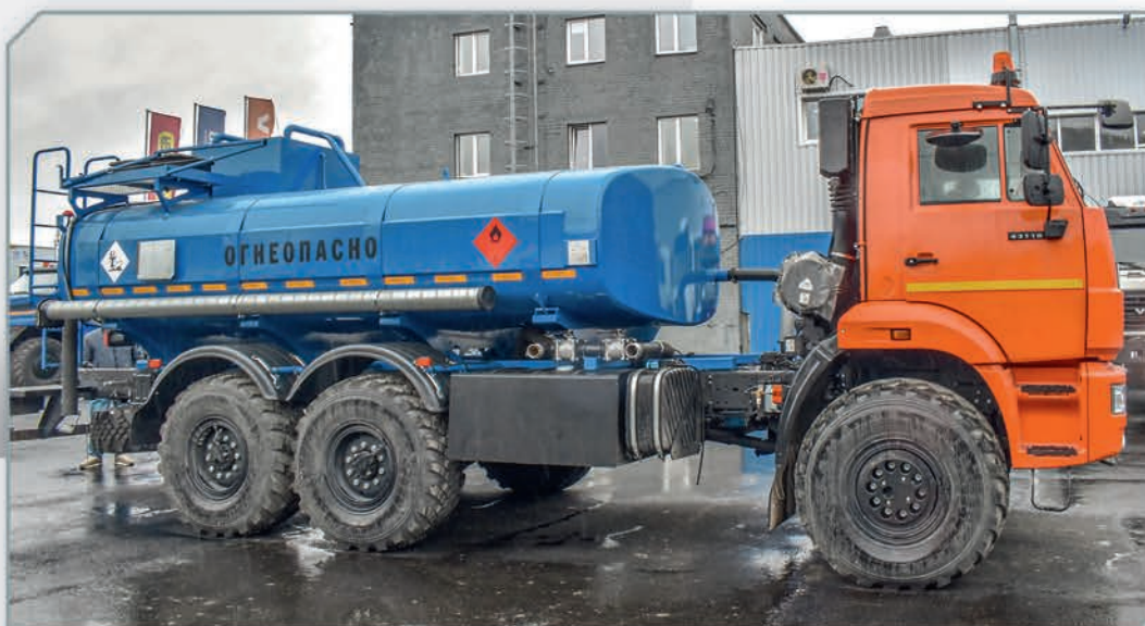
АЦН на базе шасси КамАЗ 65115
