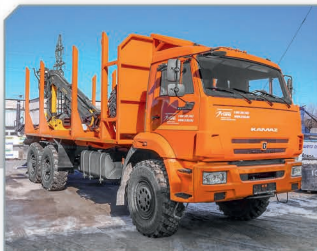
Сортиментовоз с гидроманипулятором VM10L74M на базе шасси КамАЗ 43118-3027-46
