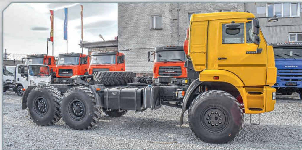
Седелный тягач с доработками под ДОПОГ на базе шасси Камаз 53504
