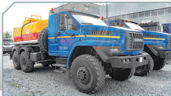
АЦВ-10 на базе шасси Урал 4320-6952-72Е5Г38
