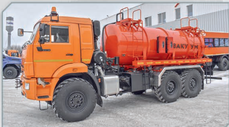
АКН-10 на базе шасси Камаз 43118
