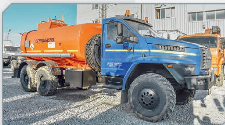
АТЗ-12 на базе шасси Урал 4320-6952-72
