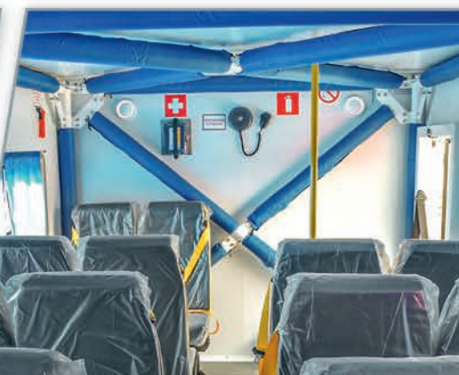
усиленная система безопасности фургона
