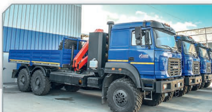
Партия бортовых автомобилей с КМУ РК8500А на метановом шасси Урал 4320
