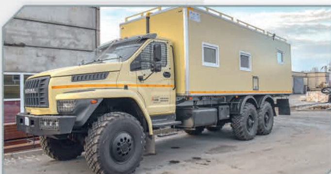
Автодом на базе шасси Урал Некст 4320
