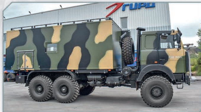
ТБМ на базе шасси МАЗ
