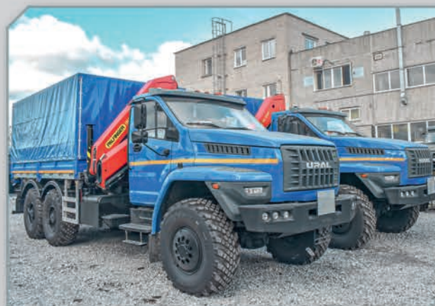
Бортовой автомобиль с тентом и КМУ ИМ-150N
