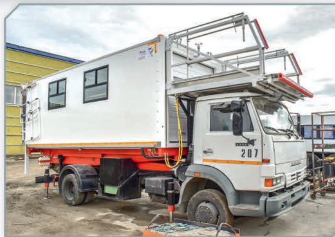
Амбулифт на базе шасси Камаз 4308
