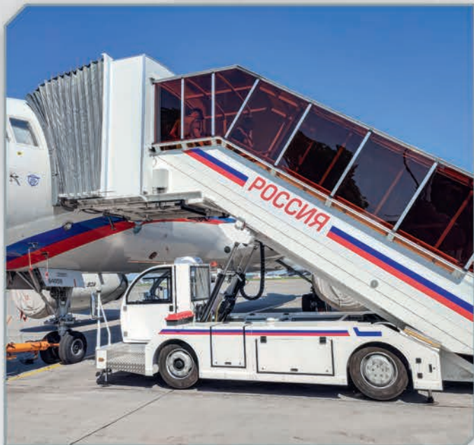
Трап самоходный, пассажирский с галерей и капюшоном ТСП-ГИРД-2.000
