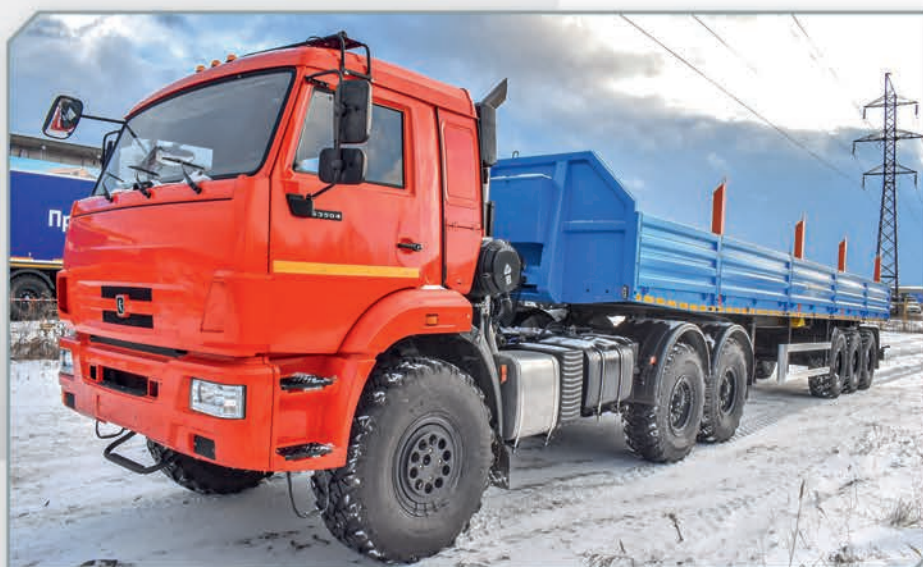
Седельный тягач с бортовым полуприцепом на базе шасси Камаз 53504
