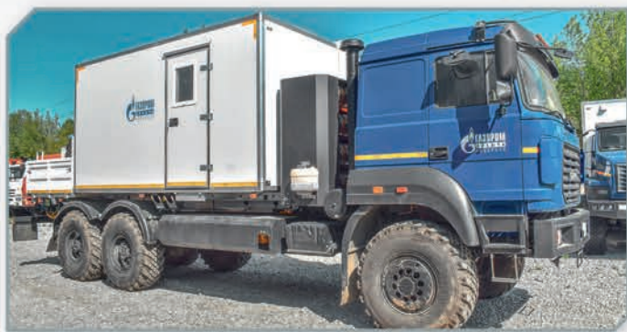
Передвижная мастерская ПАРМ с КМУ ИНМАН ИМ 20 на газовом шасси Урал 4320
