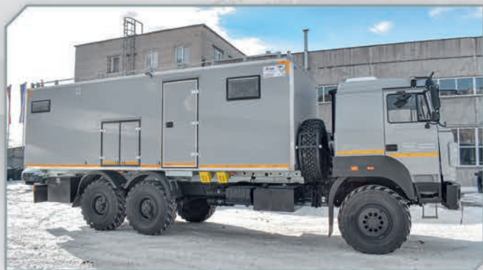
ТБМ на базе шасси Урал 4320
