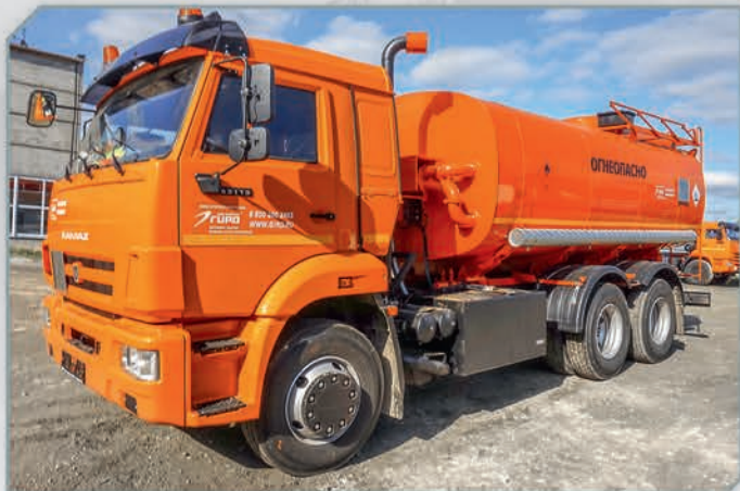
АЦН на базе шасси КамАЗ 65115
