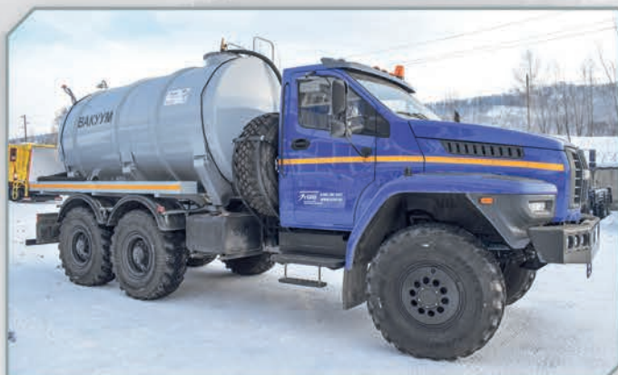
МВ-10 на базе шасси Урал 5557-72
