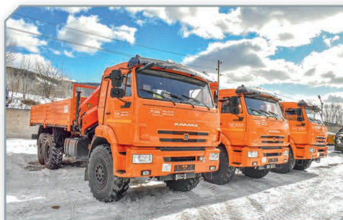
Бортовые автомобили с КМУ Палфингер РК15500А на базе шасси Камаз 43118
