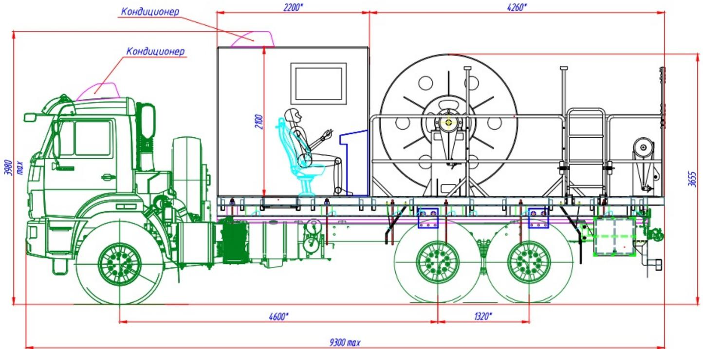
Кабелеукладчик на шасси КамАЗ 43118-50. Кузов-фургон изготовлен из 5-слойных сэндвич-панелей собственного производства, в фургоне расположена установка оператора. Барабанная установка расположена за фургоном
