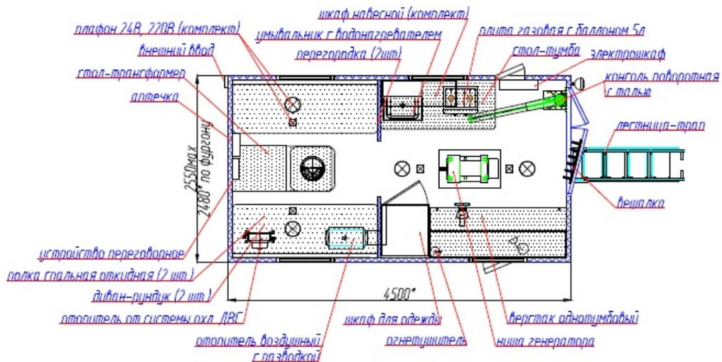
Передвижная лаборатория на шасси Урал 5557-6152-72. Фургон изготовлен из 5слойных сэндвич-панелей собственного производства по бескаркасной технологии фургоностроения.
