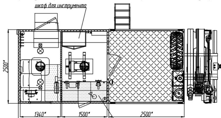
Передвижная ремонтная мастерская ПАРМ с бортовой платформой на шасси КАМАЗ 43118-3086-50. Кузов-фургон изготовлен из 5слойных сэндвич-панелей собственного производства. Крано-манипуляторная установка Инман ИМ-150N.
