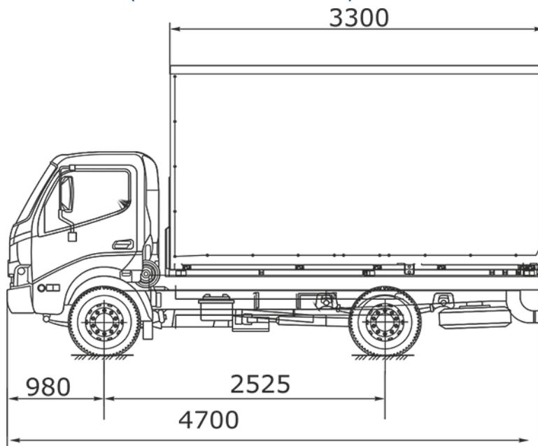
Алюминиевая бортовая платформа с тентом (распашные ворота) на давальческом шасси HINO XZU600L-НКММРW3; наружные размеры бортовой платформы 3300x2000x2000(598)мм
