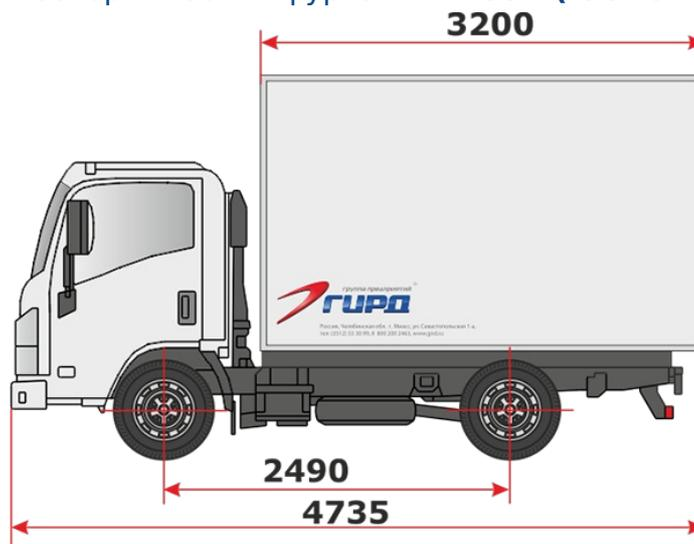
ГП ГИРД выпустило хлебный фургон на шасси Isuzu NLR85 с габаритными размерами фургона 3500x2000x1900мм.
